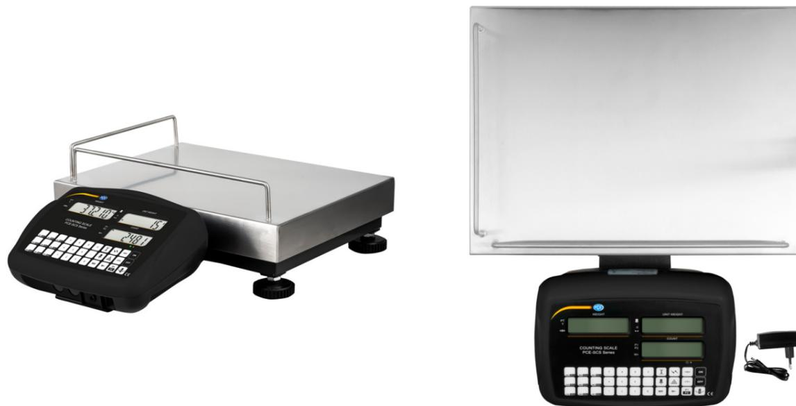
**Bilancia a piattaforma economica fino a 60 kg / Risoluzione: 5 g / Alimentazione a batteria e rete elettrica / Display LCD da 20 mm / Piattaforma in acciaio inox rimovibile / Funzione tara**
