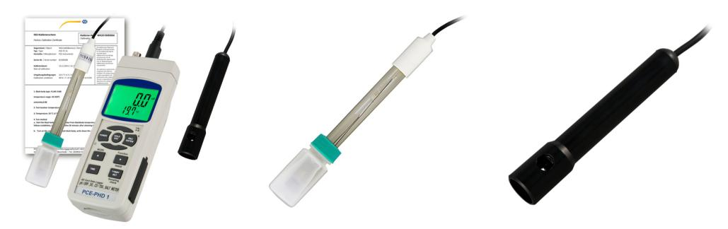
pHMetro per la misura di: pH, conduttività, ossigeno (opzionale) etemperatura (opzionale)/ Memory card SD (fino a 16 GB) / Dati archiviati in formato Excel / Ampio display / Interfaccia RS-232 e software opzionale per la trasmissione dei dati in tempo reale / Certificazione ISO inclusa
