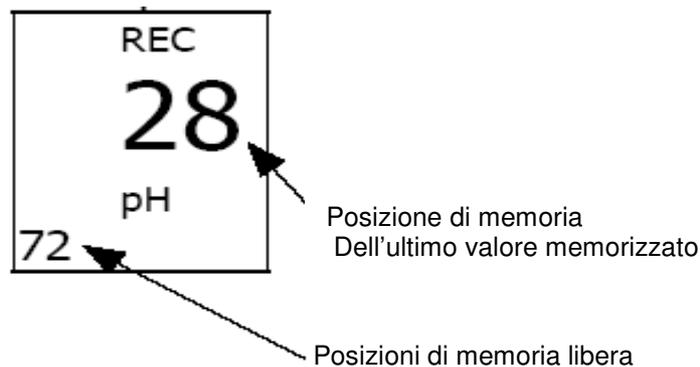
Per uscire dalla funzione di memoria mantenga premuto il tasto "Rec" durante 2 secondi. Lo strumento torna automaticamente al modo di misurazione normale.
