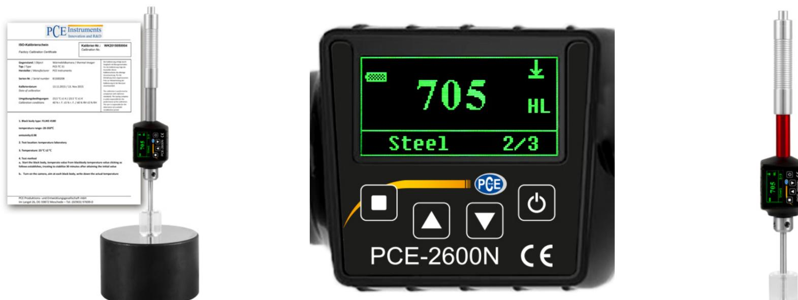
**Durometro PCE-2600N-ICA per la misura della durezza superficiale / OLED / Struttura compatta / Misuratore portatile alimentato a batteria / Valore limite di allarme / Misura a 360° / Certificazione ISO inclusa**
