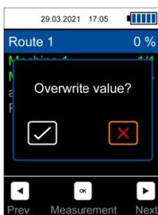
Fig. 21 Sovrascrivere la misurazione di un punto de misurazione per la misurazione del percorso corrente
