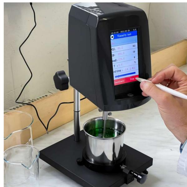
**Viscosimetro Krebs con interfaccia per PC / Certificazione ISO opzionale / Display touch screen / Unità di misura: KU, cP, g / Range di misura: 40,2 ... 141 KU / Altezza regolabile / Per misurare la viscosità dei liquidi / Protezione da sovraccarico / Software opzionale**
