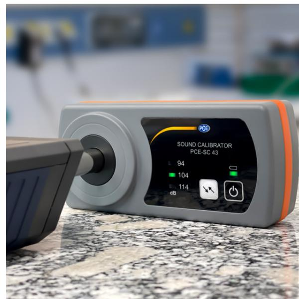
**Calibratore acustico con differenti livelli di pressione sonora / Precisione 10,4 dB / Frequenza: 1000 Hz per ponderazioni di frequenza A, B, C e D / Apertura microfono 1/2" / Alimentazione a batterie / Classe 2ª**
