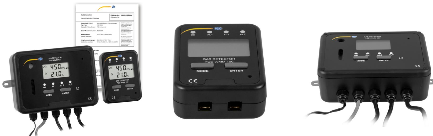
**Misuratore di anidride carbonica e ossigeno / Allarmi impostabili / Display LCD / Composto da una unità principale ed una remota / Contatto relè / Uscita analogica / Certificazione ISO per CO2**
