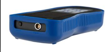
Durometro moderno e dinamico con display a colori / Memoria / Per metalli / Unità di misura: Vickers, Rockwell, Brinell, Leeb, Shore e resistenza alla trazione / Certificazione ISO inclusa
