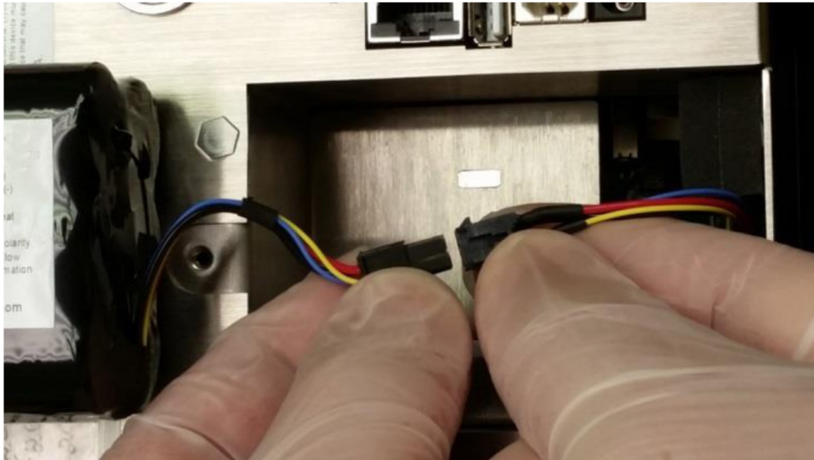
Passo 3 - Inserire lo spinotto di connessione della batteria nella presa corrispondente nel vano batteria.
