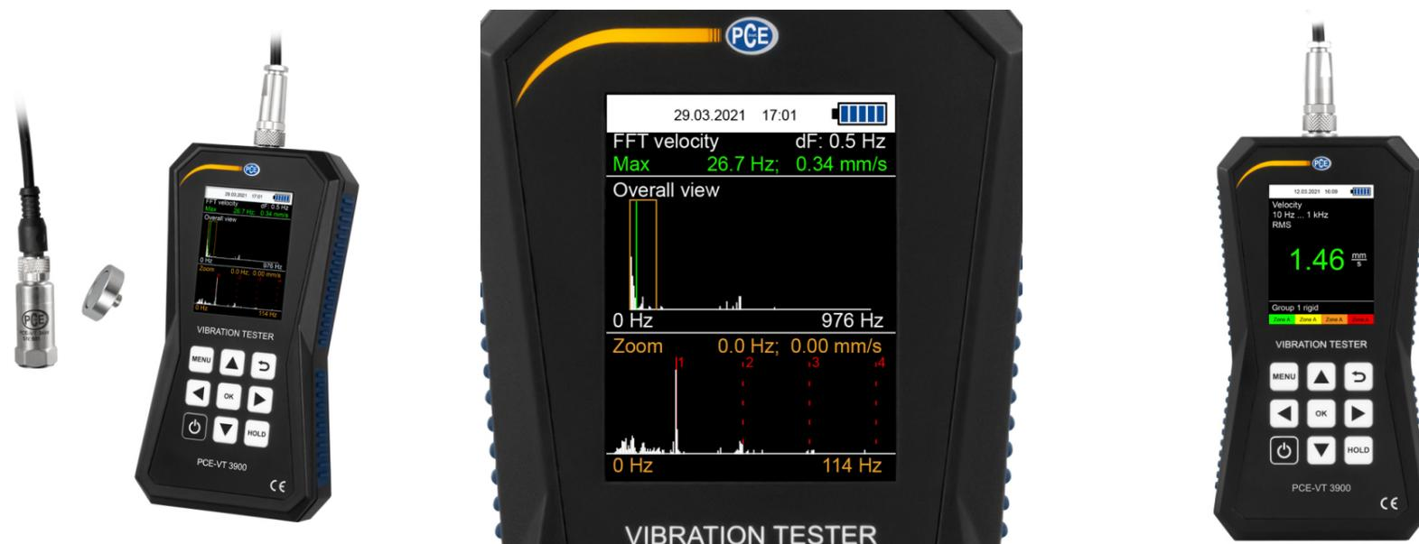
**Misuratore di vibrazione FFT con memoria interna / Percorsi di misura / Batteria ricaricabile / Software per analisi dei dati / Interfaccia PC / Range di misura fino a 399,9 m/s<sup>2</sup> / Opzionale: certificazione ISO**
