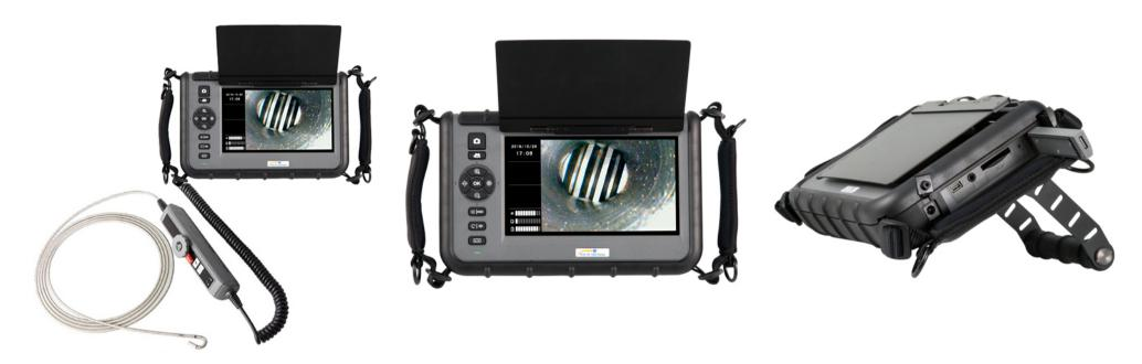
Testina articolata bidirezionale / Registrazione di immagini e video / Ampio display LCD da 7"/ Registrazione su scheda SD / Consente di ruotare l'immagine di 360° (in step di 90°) / Testina con illuminazione LED / Diametro sonda 4,5 mm
