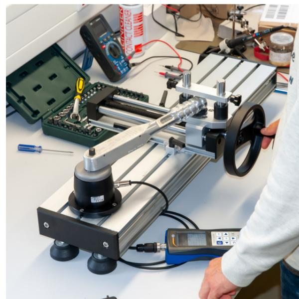
**Dinamometro fino a 50 Nm / Sensore di coppia esterno 1/2" quadrato / Display grafico / Funzione Peak / Frequenza di campionamento max. 1600 Hz / Software incluso / Certificazione ISO inclusa**
