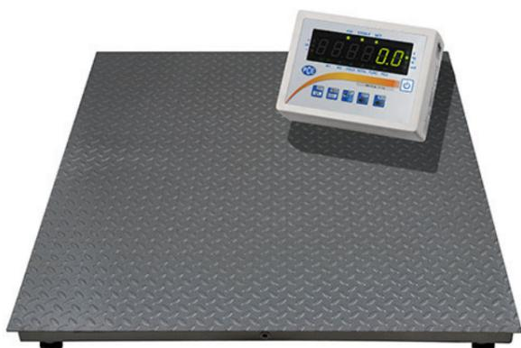
**Bilancia per barili fino a 6.000 Kg / Risoluzione da 2 Kg / Interfaccia RS-232 bidirezionale / Tara multipla su tutto il range / Funzione conta pezzi / Opzionale: uscita analogica 4-20 mA, 0-10 V, contatto commutato OC, etc...**
