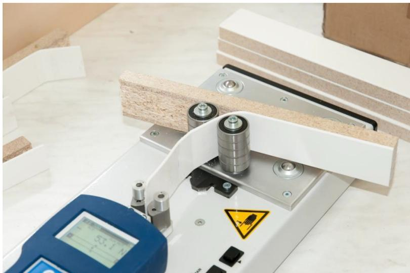
7. Quando si raggiunge la posizione finale, l'attuatore del carrello si blocca automaticamente. Il carrello si blocca anche nel caso che durante il processo di misurazione vengano superate forze di 500 N.
