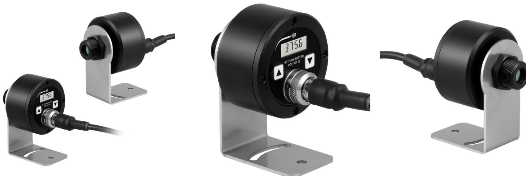
**Sensore di temperatura per installazione fissa / Uscita 4 ... 20 mA / Range: 0 ... 600 °C / Grado di emissione regolabile / Struttura in acciaio inox / IP65**
