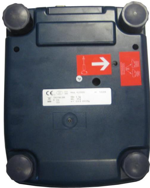
c) Nivellieren Sie die Waage mittels der Stellfüße bis die Libelle im Zentrum ist. Ein stabiler Standort der Waage ist sehr wichtig.
