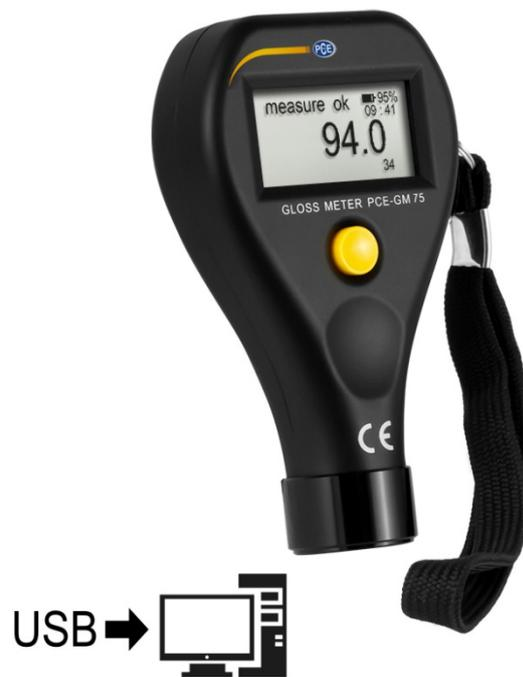
Il tester per superfici ha un'apertura di misura con diametro di 4,5 mm. Grazie a questa apertura del tester per superfici è possibile misurare su superfici molto piccole. La precisione dell'1% rende questo tester per superfici un dispositivo ideale per effettuare misure di alta precisione. L'uso con una sola mano consente di misurare in modo rapido e preciso.
