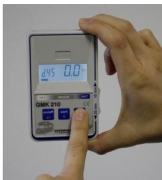
Anche in modalità misurazione, lo strumento va azzerato di tanto in tanto: alzare lo strumento in aria come da immagine e premere il tasto „hold“ per 2 secondi.
