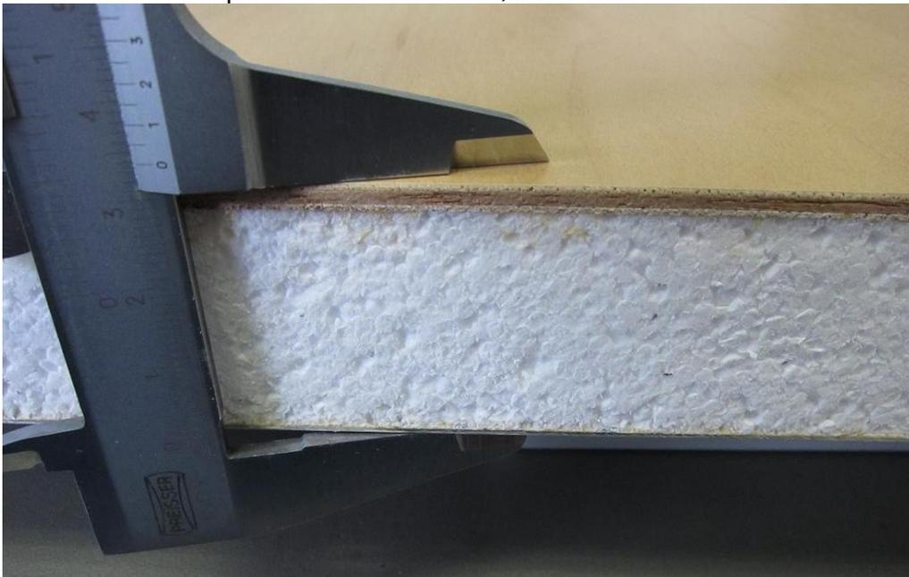
*Esempio sandwich: alluminio- isolamento - compensato*
