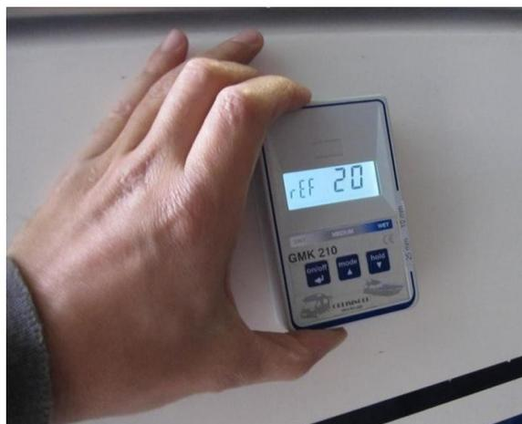
Impostazioni raccomandate dello strumento: Curva caratteristica "GrP", %u, interruttore di profondità di misura a 25mm.
