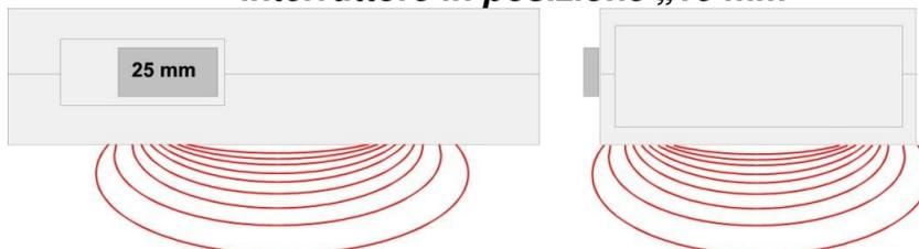
**Visione laterale: Range di misura e profondità di penetrazione con interruttore in posizione „25 mm“**
