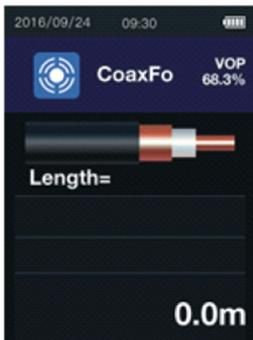
Modalità di misura per cavi coassiali e cavi collegati al dispositivo tramite adattatori di misura.
