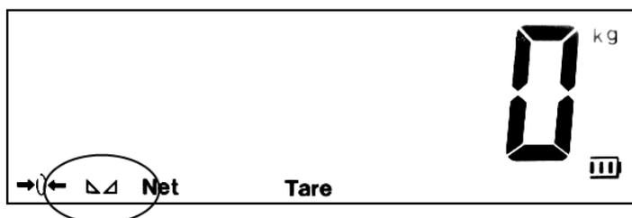
Si la balance ne réagit pas, vérifiez que l'écran reçoit correctement l'alimentation. Si l'indicateur de stabilité n'apparaît pas sur l'écran, réviser la surface sur laquelle la balance est posée et posez-la bien.
