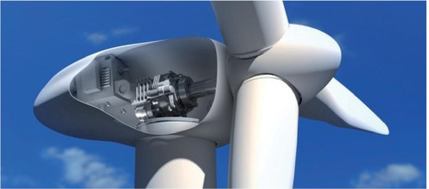
Les générateurs éoliques supportent une grande énergie qui cause une usure accrue. Les endoscopes sont utilisés même pour ce type de générateurs d'énergie. On doit prêter spéciale attention aux engrainages. Ils se trouvent à une hauteur qui ne permet pas de changer l'engrainage à court terme (dans les installations à l'extérieur cela est encore plus compliqué).
