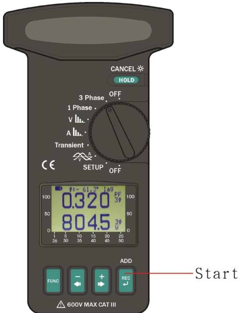
Les utilisateurs peuvent appuyer sur la touche REC une fois pour initier le registre de données programmé. Le **TEMPS D'INITIALISATION** et le **TEMPS DE FINALISATION** sont réglés dans le menu de configuration. Lorsqu'on appuie sur la touche REC, les utilisateurs pourront voir l'écran suivant.
