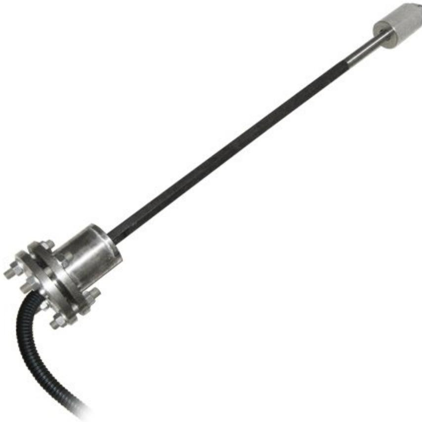
Ce mesureur d'humidité utilise aussi le principe de mesure d'ondes dans la bande VHF. Le mesureur microondes se compose d'une boîte avec l'unité électronique et le propre mesureur d'humidité. La pièce du mesureur est fabriquée en deux variantes. Les deux sont construites en acier inoxydable AISI321 (diamètre du tube: 15 ... 30 mm). Cependant, elles se différencient par leur forme de construction.
