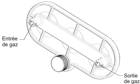
1. Pour installer la plaque d'adaptateur de débit, fixer la plaque sur les grilles du capteur et visser le serre-joint jusqu'à ce que la plaque tienne bien en place.
