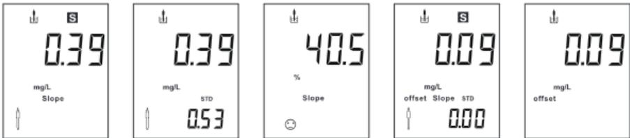
Plongez l'électrode dans la solution tampon, l'icône stabilisée s'affiche en haut de l'écran une fois que les données se sont stabilisées. Appuyez sur la touche
