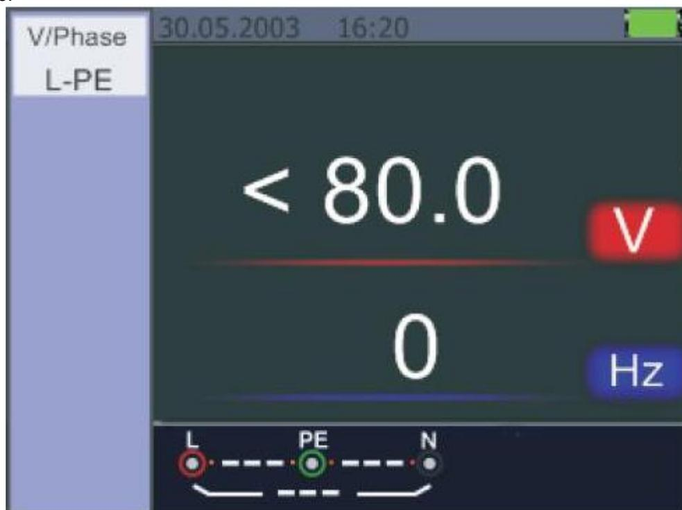
Img. 5.2.7.1 Écran Standby pour la tension et la fréquence
