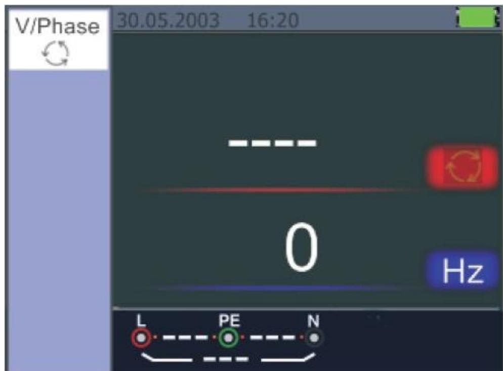
Img. 5.2.8.1 L'image de démarrage de la mesure de la séquence de phase
