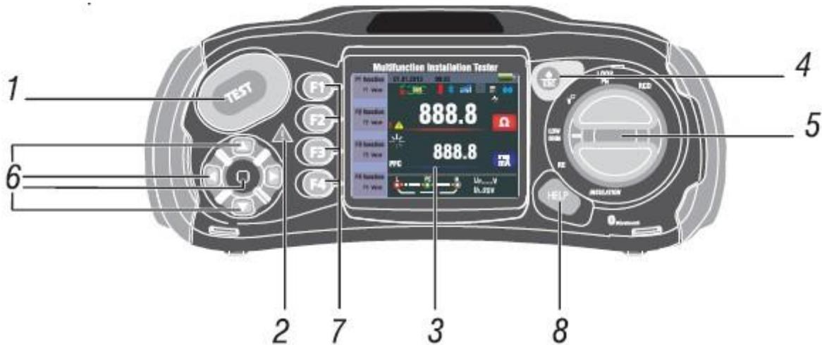
1. Démarrage du test sélectionné. La touche **T** est entourée d'un „Touch Pad“. L'écran tactile mesure le potentiel entre l'utilisateur et le terminal PE de l'appareil d'essai. Si la valeur de seuil de 100V est dépassée, le symbole **D** s'allume sur le „Touch Pad“.
