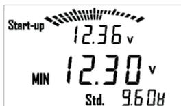
La tension la plus faible pendant le processus de démarrage ne doit pas être inférieure à 9,6 V pour une batterie (12 V) et à 16 V pour deux batteries (24 V).
