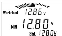
La tension minimale de charge sous la charge maximale ne doit pas être inférieure à 12,80 V pour une batterie (système de 12 V) et à 25,60 V pour deux batteries (système de 24 V).
