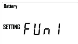
5. Utilisez les touches « ▲/▼ » pour sélectionner le standard de la batterie à vérifier et confirmez avec la touche « ENTER ». (Autocollant ou impression sur la batterie)
