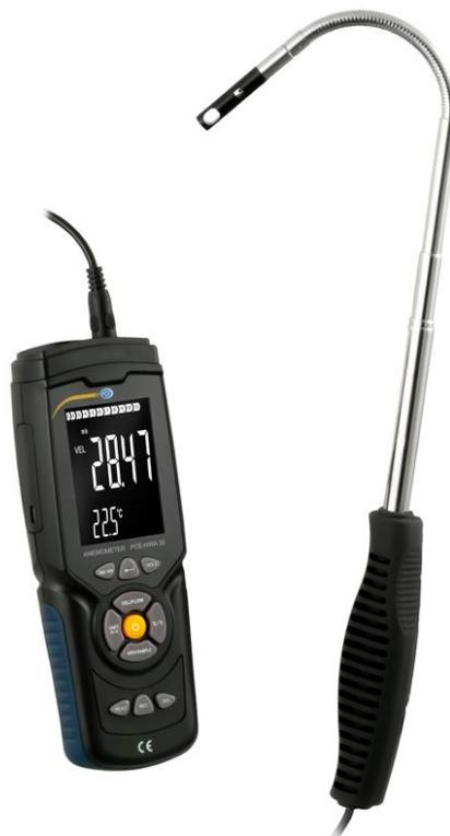
L'anémomètre mesure la vitesse du vent au moyen d'un fil chaud. Cela permet d'avoir un dispositif au design particulièrement compact. La plage de mesure de l'anémomètre est comprise entre 0,3 et 30 m/s. En plus de mesurer la vitesse du vent, l'anémomètre mesure aussi le débit et la température ambiante. Vous pouvez visualiser la valeur de mesure ainsi que l'échelle de Beaufort. Cette échelle vous indique la force actuelle du vent.
