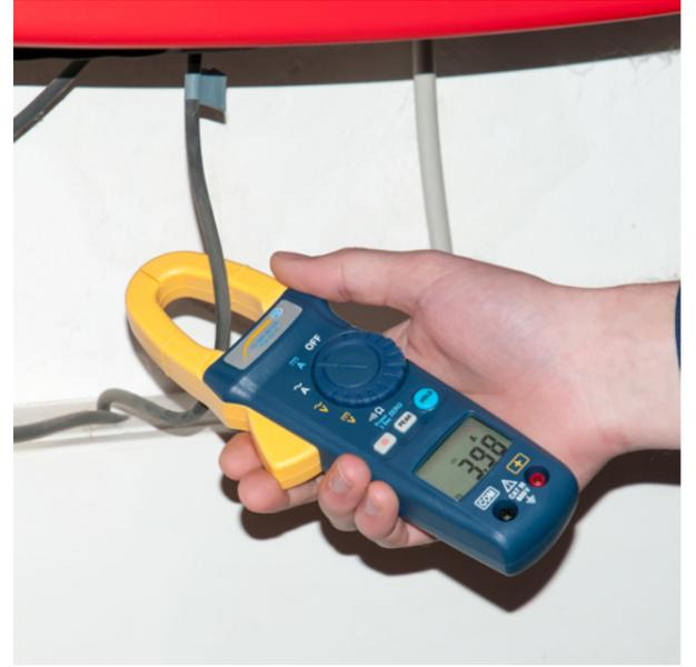
**Multimètre pour mesurer la tension jusqu'à 600 V / Mesure du courant jusqu'à 600 A / CAT III 600 V / Mesure de la résistance jusqu'à 1000  $\Omega$  / Mesure sans contact par un mécanisme à pinces**
