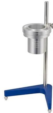
Coupe de viscosité monté sur le support optionnel
