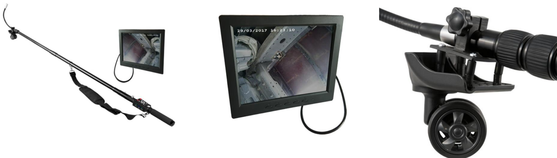
**Vidéoscope pour le diagnostic et la vérification dans des zones à accès difficile / Pour le diagnostic sur des machines et des installations / Moniteur LCD de 8" / Tête de la caméra avec 12 LEDs lumineuses / Éclat des LEDs ajustable / Fonction d'enregistrement / Fonction de vidéo / Tête flexible**
