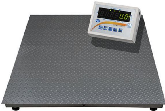
**Balance commerce vérifiable/ vérifiée jusqu'à 3000 kg / résolution à partir de 1 kg / interface RS-232 bidirectionnel/ tarage enregistrable / fonction comptage de pièces / option: sortie analogique 4-20 mA, 0-10 V, contact commuté OC, etc.**
