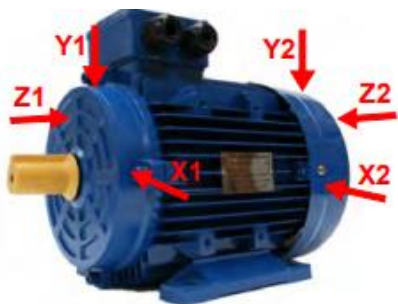
Image 11: Points de mesure dans les moteurs électriques
