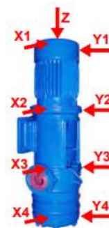
Image 12: Points de mesure dans des machines à moteur vertical
