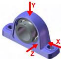
Image 9: Points de mesure dans les paliers verticaux
