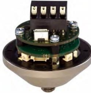
Image 1: bornes de connexion et connecteur USB dans le PCE-VS11
