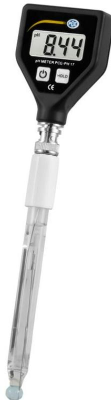
L'analyseur d'eau PCE-PH 17 est un mesureur de pH avec une électrode totalement en verre. Le fait qu'elle soit en verre permet que le nettoyage de l'électrode soit plus simple et approfondi. L'analyseur d'eau mesure avec une précision de  $\pm 0,1$  pH et une résolution de 0,01 pH. Grâce à cela, l'analyseur d'eau est un appareil idéal pour des applications simples en laboratoire.
