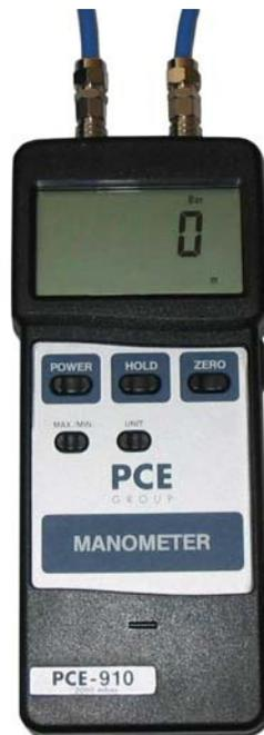
Avec le mesureur de pression numérique PCE vous pourrez mesurer la pression différentielle. Le mesurer de pression est idéal pour effectuer des mesures dans le domaine du chauffage, la climatisation (HLK), de l'hydraulique, la médecine, la pneumatique et les applications informatiques, ainsi que des mesures au laboratoire. Cet appareil peut s'utiliser pour mesurer des moyens liquides –sauf acides et eaux de javel, ainsi que des gaz qui contiennent particules d'acides et eaux de javel.
