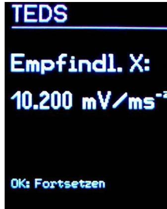
Les requises sont capteurs avec de la fonction TEDS et modèle standard Nr. 25.
