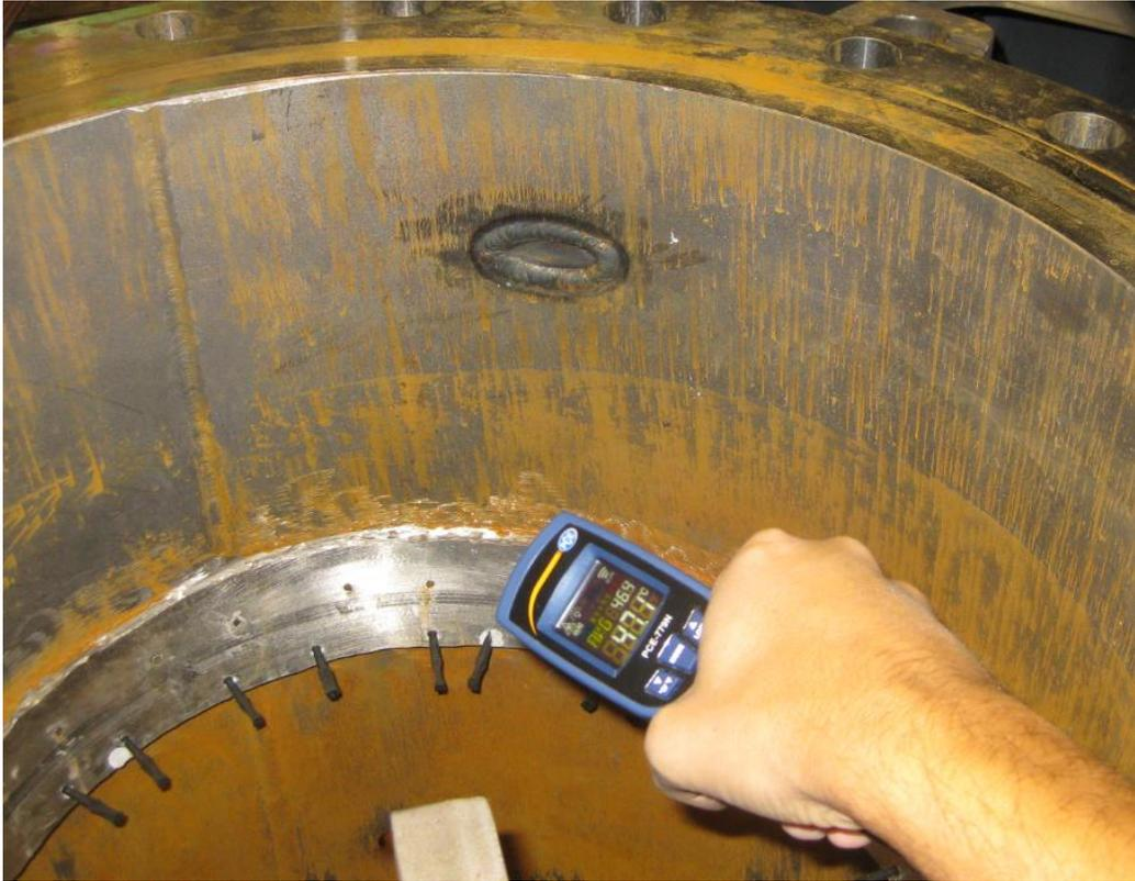
Verificação da temperatura dentro do corpo da válvula
