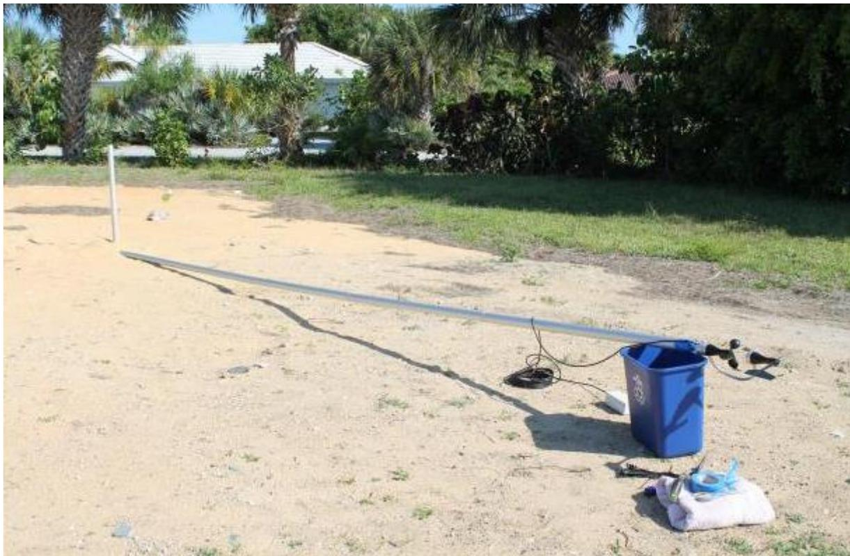
Como o registrador de dados não está conectado, consegui ampliar a extensão do cabo. Como não tinha certeza se isso poderia causar problemas, liguei para o serviço técnico da PCE. Eles me disseram que a extensão poderia ser ampliada até 15 m. Dito e feito. Alonguei o cabo e conectei-o à eletrônica, seguindo as instruções do manual do usuário.
