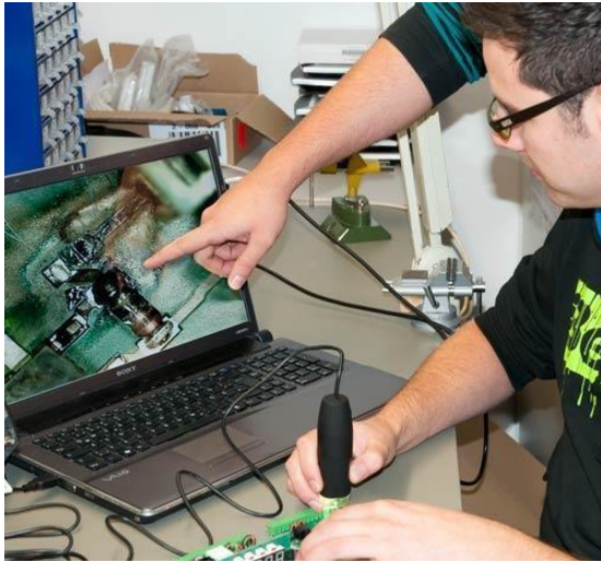
Solução de problemas em uma oficina usando o microscópio PCE-MM 200
