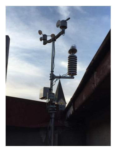
No meu caso, tive de montar uma viga na parede para cobrir a saliência no teto, de modo que pudesse instalar a estação. Além disso, montei um cano na viga, o que me permitiu atingir a altura desejada. Esses materiais podem ser encontrados em qualquer loja de ferragens. O custo adicional é de cerca de 20 euros.
