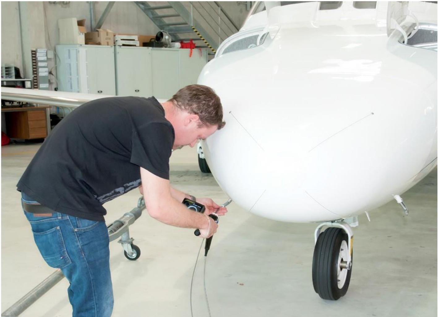
Pequenos corpos externos, parafusos soltos podem acabar nas turbinas, os danos causados por objetos estranhos (Foreign Object Damage) podem ser detectados corretamente. Podem ser examinados mais componentes, portanto, os examinadores podem inspecionar o interior da fuselagem (rachaduras).
