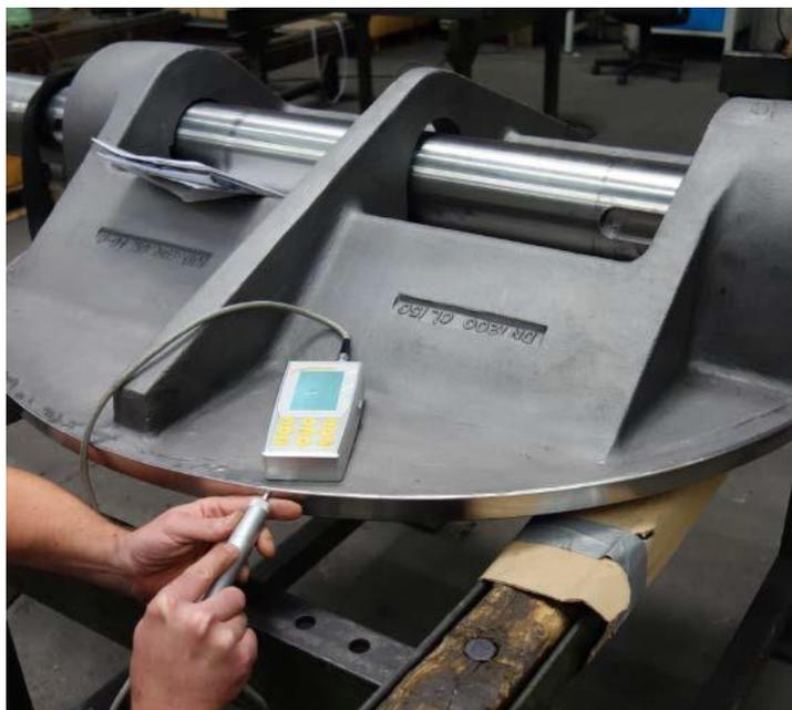
O controle de dureza na vareta da válvula, endurecido parcialmente na área de rolamento, e com um serviço de alta temperatura superior a 750 °C.
