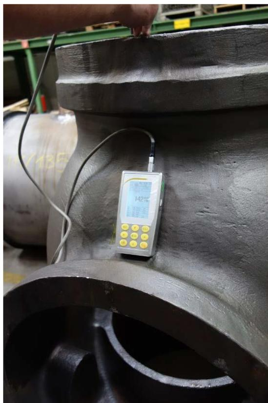
Controle final das válvulas de borboletas fabricadas em aço inoxidável:
