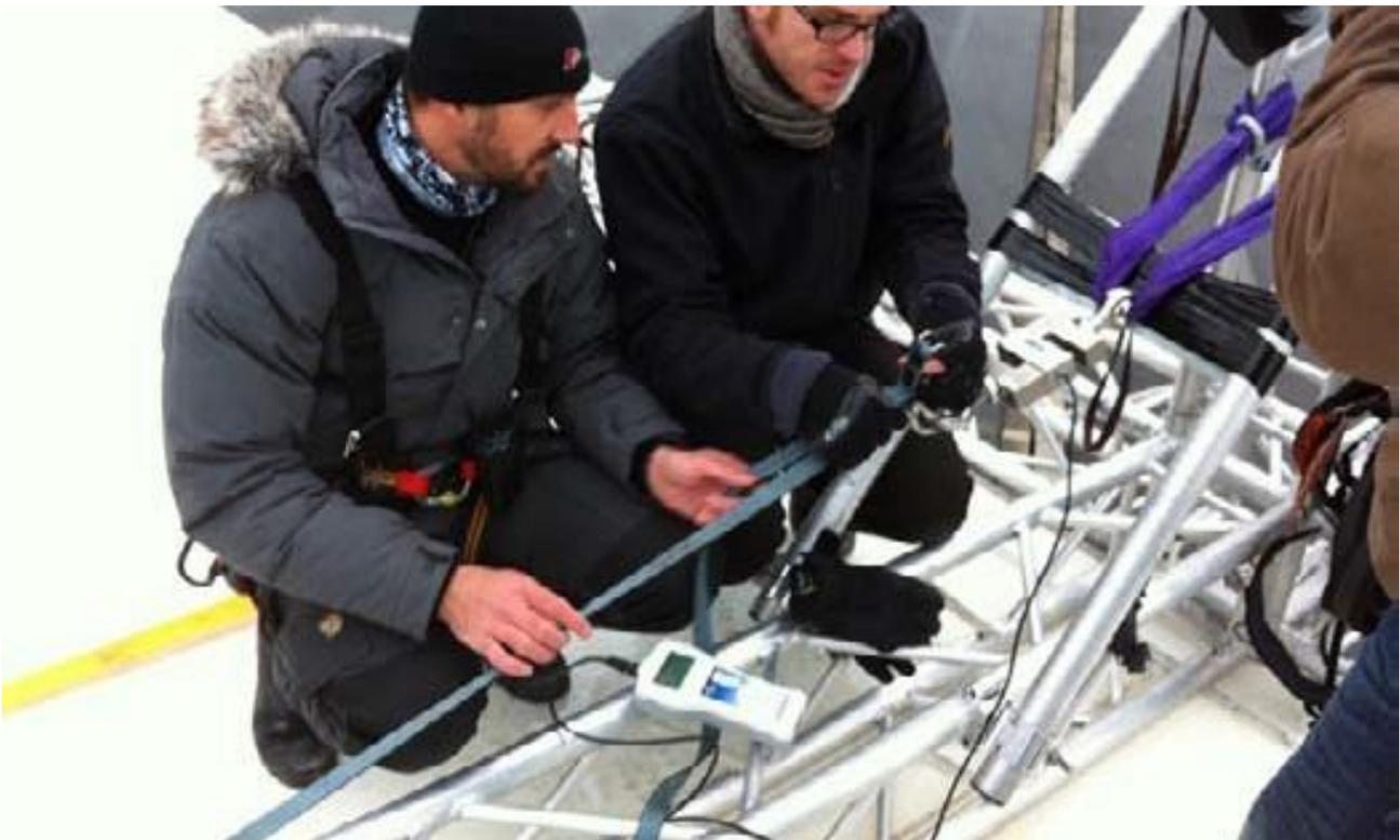
Por razões de segurança, a verificação foi realizada primeiro de forma estacionária. A velocidade dos caminhões foi simulada pelo vento artificial. A força do vento foi medida pelo anemômetro PCE-A420, um anemômetro de conchas digital com o qual a direção do vento não afetou a medição. Mesmo de forma estacionária, a manobra parecia impossível a 80 km/h, já que a pressão do vento era enorme.
