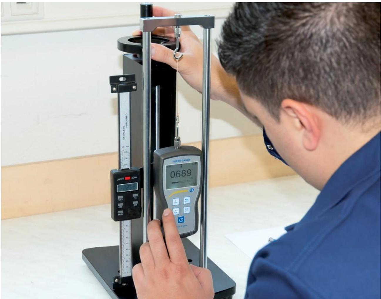
Um medidor de força é útil mesmo nas aplicações menos esperadas, por exemplo, há um leitor especial da força dos ovos, um dispositivo que ajuda medir o nível de força necessário para quebrar a casca de um ovo. Ao utilizar este dispositivo é possível encontrar a melhor maneira de transportar e comercializar o produto.
