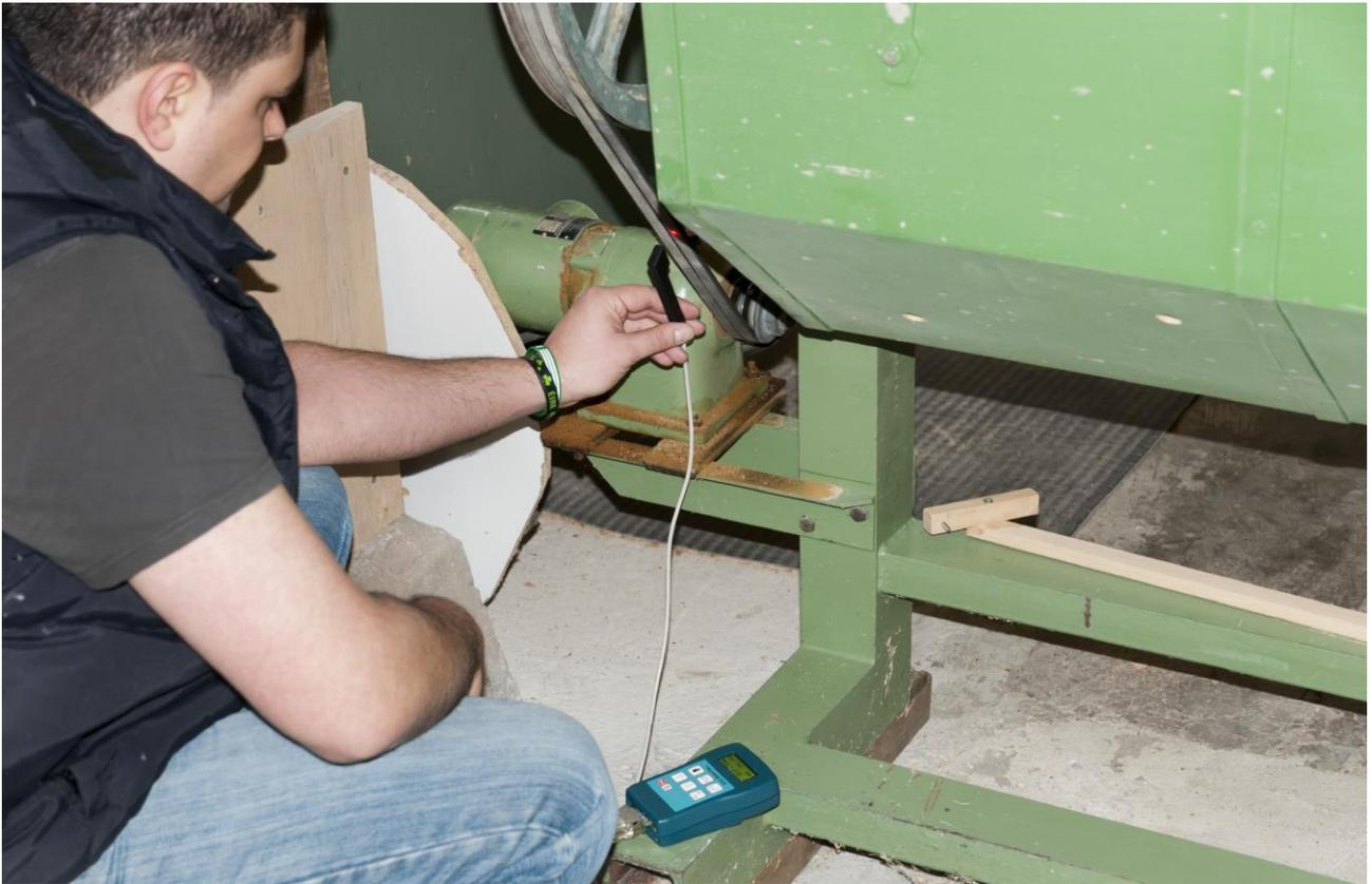
**Dispositivo para a medição da tensão de uma correia**
