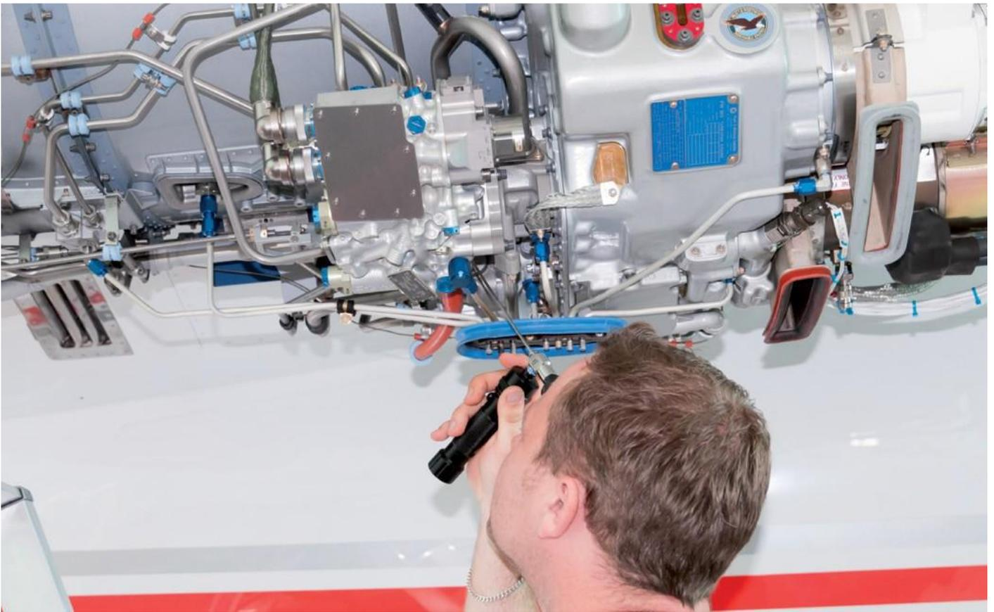
Devido as modernas câmeras endoscópicas com função de visão lateral (duas câmeras) ou cabeças de câmera totalmente giratórias, não é necessário usar espelhos. Durante a inspeção das turbinas (impulsor, etapas do compressor, câmara de combustão, turbogerador e injetores), são analisados, por exemplo, um grande número de hélices (impacto das aves – peças soltas). Se os discos da turbina (blisks) forem examinados desmontados, corresponde a um giro da turbina a gás.
