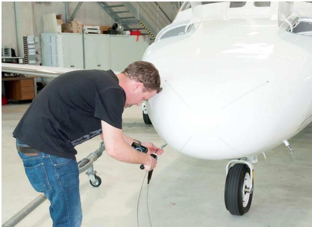
Pequenos corpos externos, parafusos soltos podem acabar nas turbinas, os danos causados por objetos estranhos (Foreign Object Damage) podem ser detectados corretamente. Podem ser examinados mais componentes, portanto, os examinadores podem inspecionar o interior da fuselagem (rachaduras).
