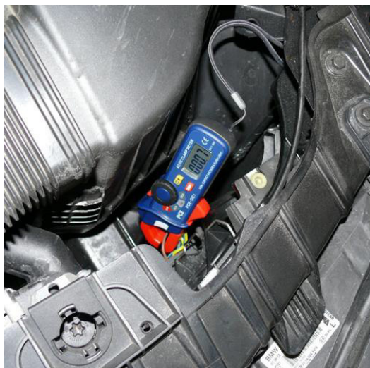
Controllo dei componenti elettronici in un veicolo con il PCE-DC 1
