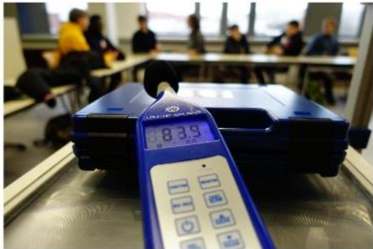
Mesure du niveau sonore dans la salle de classe.
