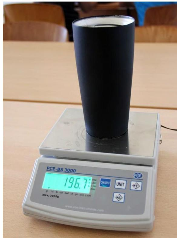
Fig. 1 – Détermination de la chaleur de fusion de la glace en utilisant la balance de laboratoire PCE-BS 3000
