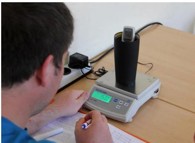
*Fig.2 – Détermination de la constante calorimétrique d'un récipient thermique*
