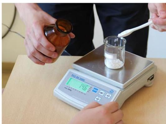
*Fig. 4 – Un étudiant pèse  $\text{CaCl}_2$ , pour déterminer la solution thermique*
